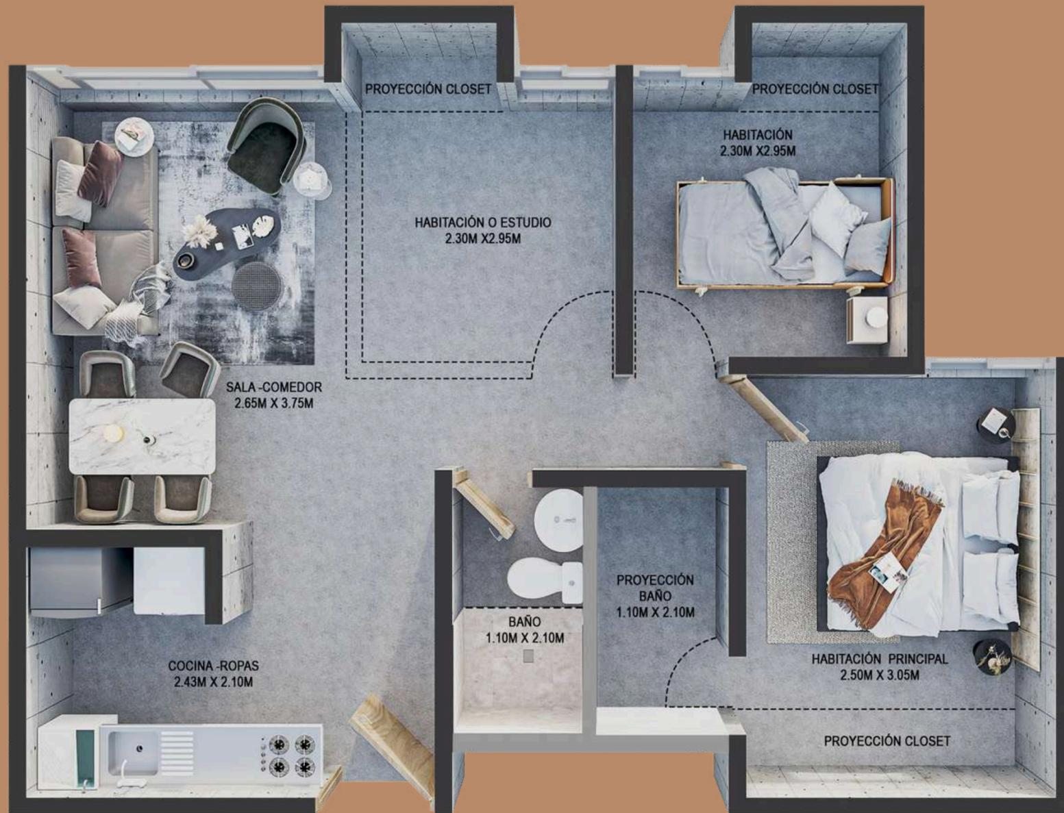
El muro punteado es proyección para que el propietario lo construya. En caso de construirlo, se deberá hacer en sistema liviano por recomendación técnica del diseñador. La constructora no entrega el muro construido.
